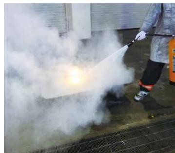
火点が広がらぬように消火剤を約2～3cmの厚さに全面散布。燃焼金属上に被膜を作ります。
