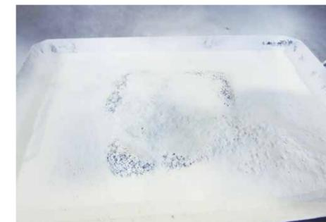
消火直後は全体的に白色。ただし余熱の強いところ、消火剤の散布が十分でないところは褐色から黒褐色に変わりはじめます。その部分めがけてさらに消火剤を放出。その後は十分に冷却するまで放置します。
