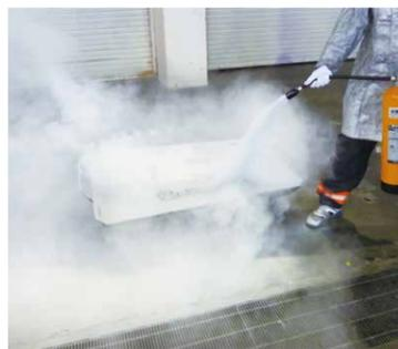
消火剤を大量放出することで空気を遮断、さらに冷却作用によって火勢を制圧、消火します。
