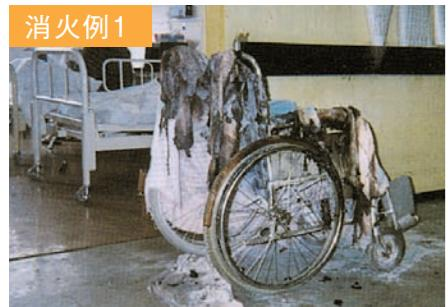
平成6年3月、北海道A病院の病棟廊下に放置してあった車椅子の毛布から出火、火は一瞬のうちに天井近くまで達したが、すぐに感知器が作動し、スプリネックス本体が作動、瞬時に消火しました。原因はタバコの不始末、被害は車椅子1台と壁及び廊下が多少濡れた程度で、あと数分消火が遅れたら壁から天井へと延焼し、煙の充満で大混乱となるところでした。当日、入院患者さんも動搖することなく、業務も支障なく平常通り行われました。
