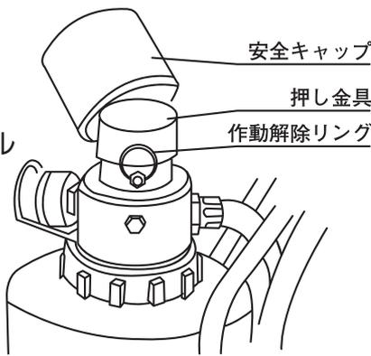
3m程度はなれた位置より、燃焼物を泡でおおいつつむようして消火薬剤を放射し消火してください。消火剤の放射中は、消火器のハンドルをしっかりと持ち、消火器を倒さないよう操作してください。
