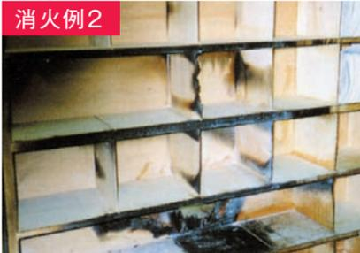
平成6年3月、北海道A病院の病棟廊下に放置してあった車椅子の毛布から出火、火は一瞬のうちに天井近くまで達したが、すぐに感知器が作動し、スプリネックス本体が作動、瞬時に消火しました。原因はタバコの不始末、被害は車椅子1台と壁及び廊下が多少濡れた程度で、あと数分消火が遅れたら壁から天井へと延焼し、煙の充満で大混乱となることでした。当日、入院患者さんも動揺することなく、業務も支障なく平常通り行われました。
