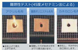
難燃性テスト(45度メセナミン法による) (カネカロン)は火源に接しても溶融しにくく、炭化する...
